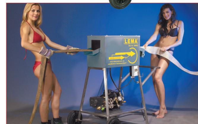
Schlauch einfach durch das Gerät ziehen, fertig. Als Aggregat kann ein bestehender Hochdruckreiniger verwendet werden. Noch besser, das SWG mit einem abgestimmten LEMA Hochdruckreiniger kombinieren. Dafür gibt es zahlreiche Varianten, stationär und mobil. Und mit verschiedenen Antriebsarten.
